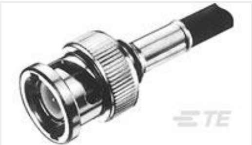
TE Part #1-1337430-0 BNC Str Plg Hex 50Ohm Silver Pltd RG174A
