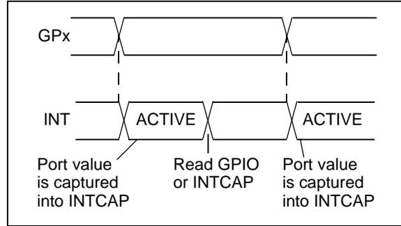
**FIGURE 1-12: INTERRUPT-ON-CHANGE FROM REGISTER DEFAULT**
