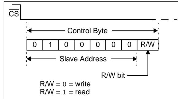
**FIGURE 1-8: I<sup>2</sup>C™ ADDRESSING REGISTERS**
