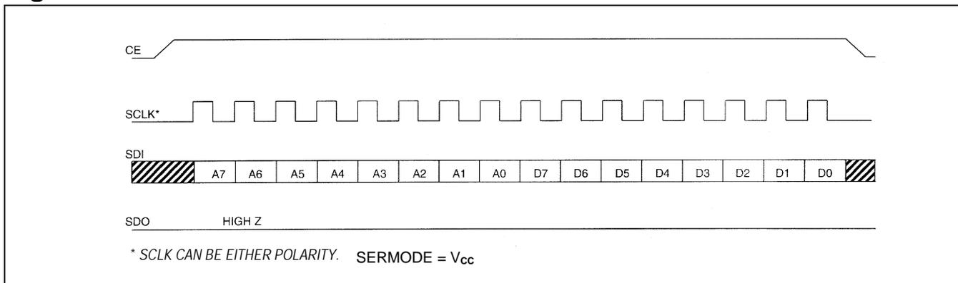
**Figure 7. SPI SINGLE-BYTE READ**
